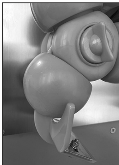
Close-up van de schiller in de gleuf
